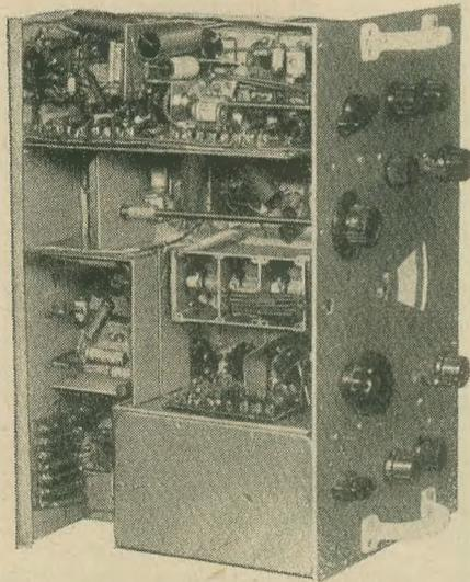
DM 2 ABM, Heinz Hollmach aus Leipzig, zeigt einen tragbaren Kurzwellenempfänger, der mit Raumladegitterröhren bestückt ist und nur eine Anodenspannung von 15 bis 20 V benötigt
